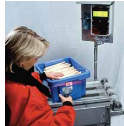
Escáner con indicación para el registro de obrero, grupo de obreros, fecha de la recogida y el campo cosechado. El registro de estos datos permite al usuario de hacer un análisis por campo así como por obrero.
