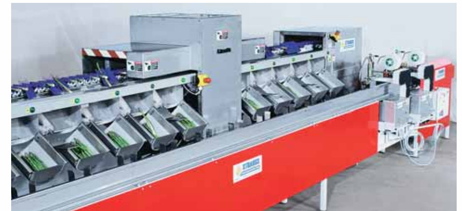
Opcionalmente: unidad cortadora en la línea con señal óptico y línea atadora.
