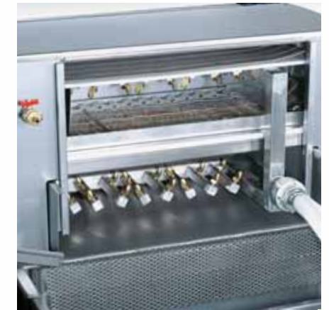
Si los espárragos que quiere clasificar son sucios, es necesario de lavarlos a través de la cinta escurridor de abajo y de arriba por válvulas especialmente concebidas. Esta limpieza excepcional es necesario para resultados óptimos de clasificación y permite de presentar sus espárragos netamente y frescamente.
