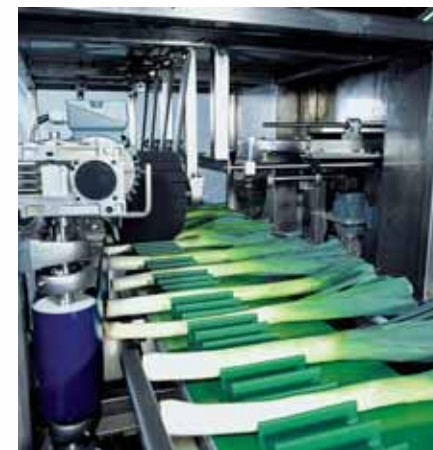
Los puerros son ajustados variablemente por una cinta que contiene los puerros y son cortados por un cuchillo con filo especial.
