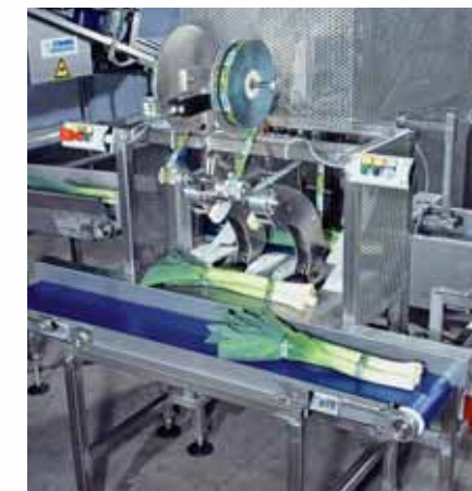
La unidad atadora concebida nuevamente enfardela los paquetes de puerros por medio de dos cintas adhesivas.
