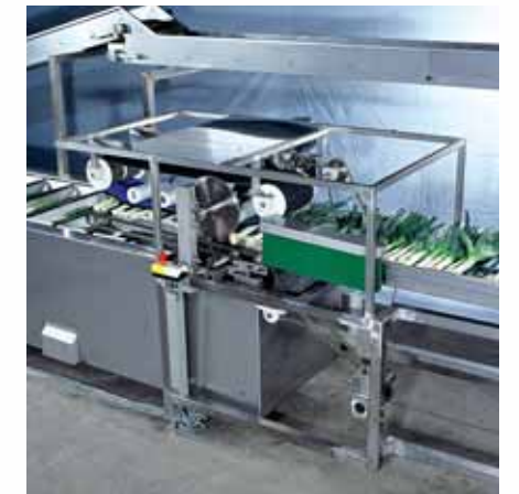
Der Porree wird variabel ausgerichtet, durch einen Niederhalter in Position gehalten und mit zwei Messern mit Spezialschliff an der Wurzel- sowie Blätterseite gekürzt.
