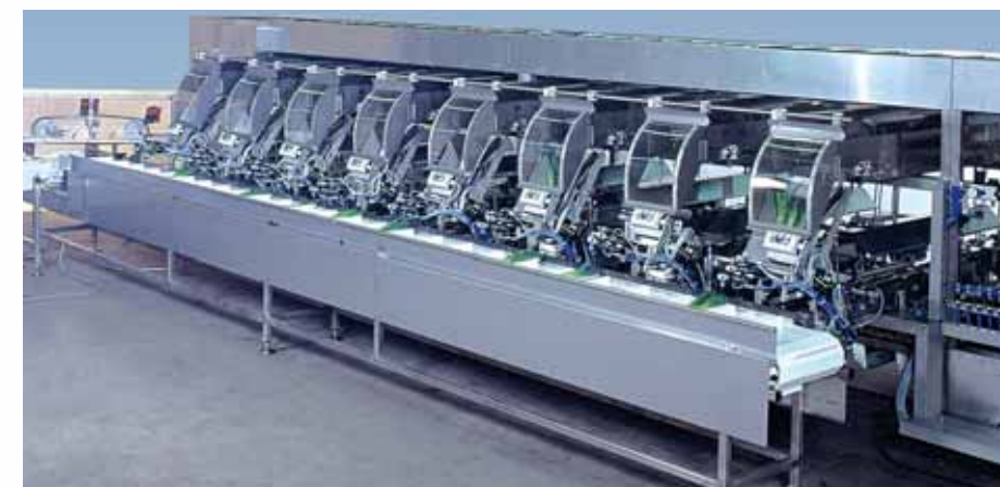
Die verwogenen Porreeeinheiten werden von den Querbändern in die Einlegeroboter transportiert. Aus dem Speicher werden aufgerichtete Pappschalen zugeführt, in die der Porree schließlich durch automatisches Öffnen der Klappe eingelegt wird.
