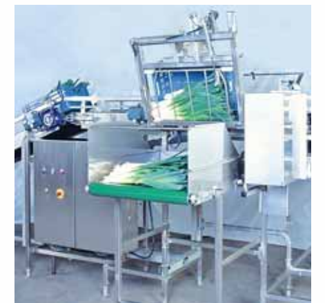
Der Porreekistenentleerer als vollautomatische und produktschonende Entleerungshilfe.
