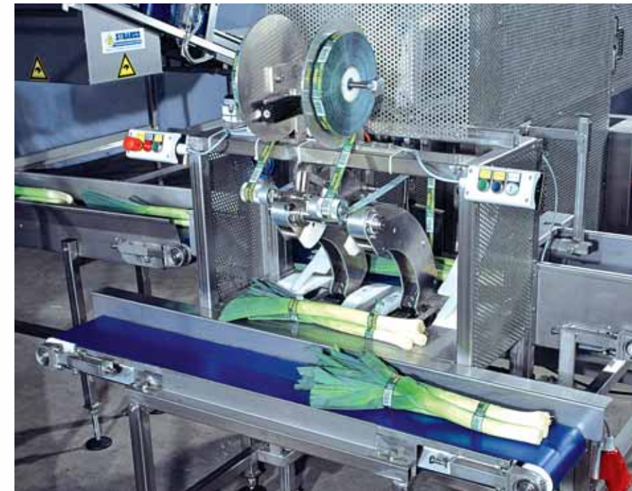
Die neu konzipierte Banderoliereinheit bündelt die verwogenen Porreepackungen mit Hilfe von zwei Klebebändern.
