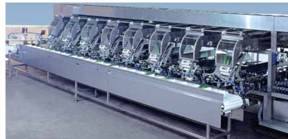
Las unidades de puerros son transportados de las cintas transversales a los autómatas de colocación. Los hollejos de cartón levantados son llevados y entonces llenados con los puerros pesados por la apertura automática del autómata de colocación.
