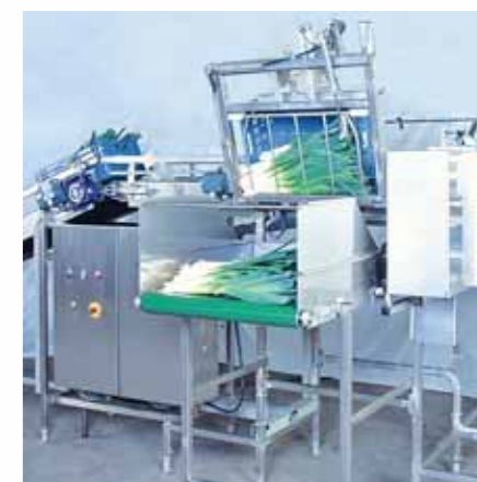
La unidad para vaciar las cajas como funcionalidad de vaciamiento automática y suave al producto.
