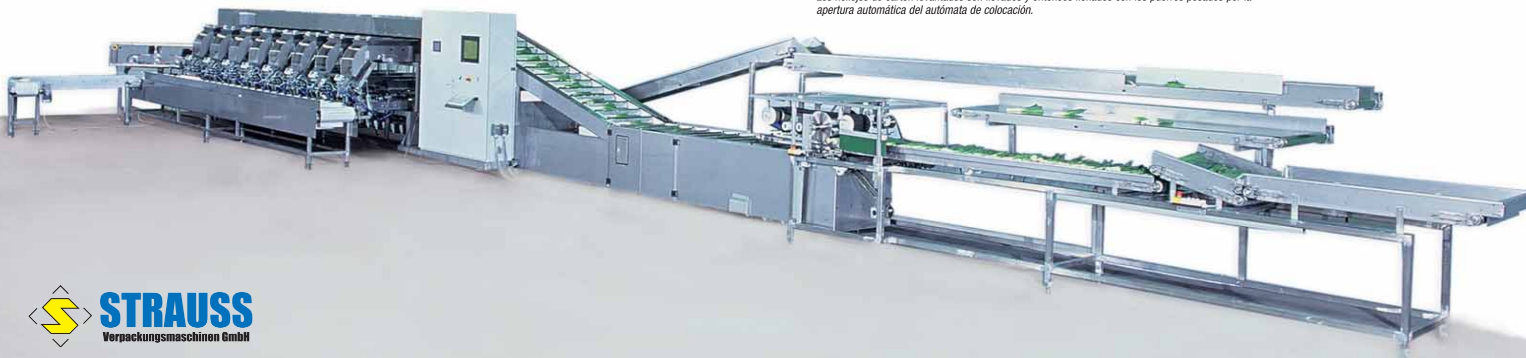
Las unidades de puerros son transportados de las cintas transversales a los autómatas de colocación. Los hollejos de cartón levantados son llevados y entonces llenados con los puerros pesados por la apertura automática del autómata de colocación.
