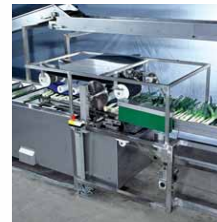
Les poireaux sont ajustés variablement et tenus en bas par une courroie – Ensuite, ils sont coupés par un couteau avec tranchant spéciale aux feuilles ainsi qu'à la racine.
