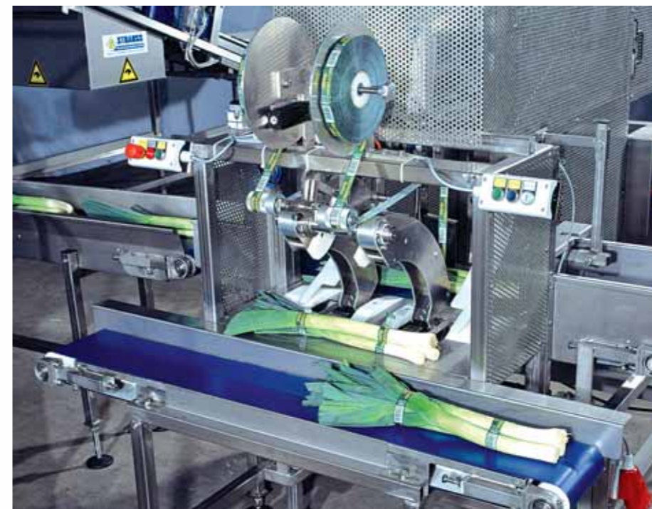
L'unité botteuse conçue nouvellement lie les paquets de poireaux pesés par moyen de deux rubans adhésifs.
