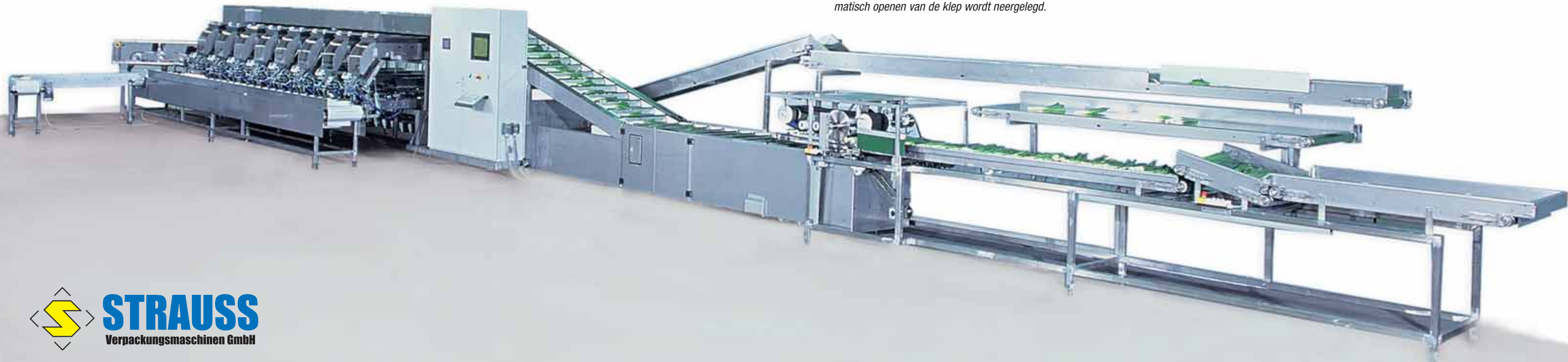
De afgewogen eenheden prei worden door de dwarsbanden naar de inlegrobots getransporteerd. Uit het voorraadmagazijn worden de kartonnen vouwschalen aangevoerd, waarin de prei door het automatisch openen van de klep wordt neergelegd.
